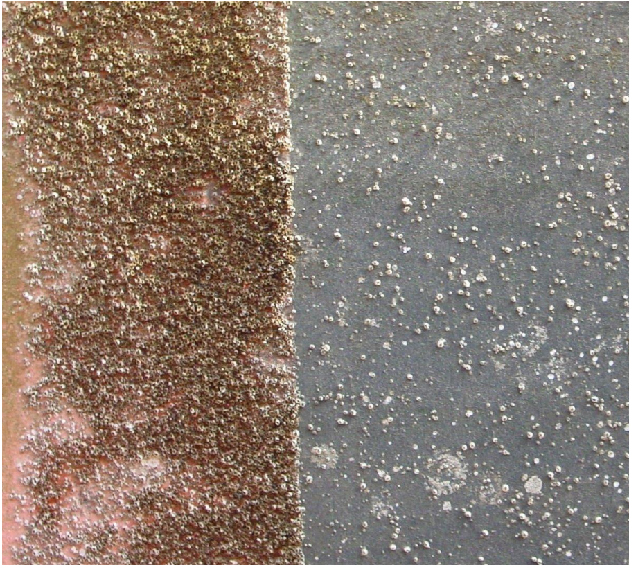
Abb. 1: Kontrollplatte zur Feststellung eines beginnenden Bewuchses, rechts wurde mehrmals gereinigt, links eine ungestörte Bewuchs-Entwicklung
