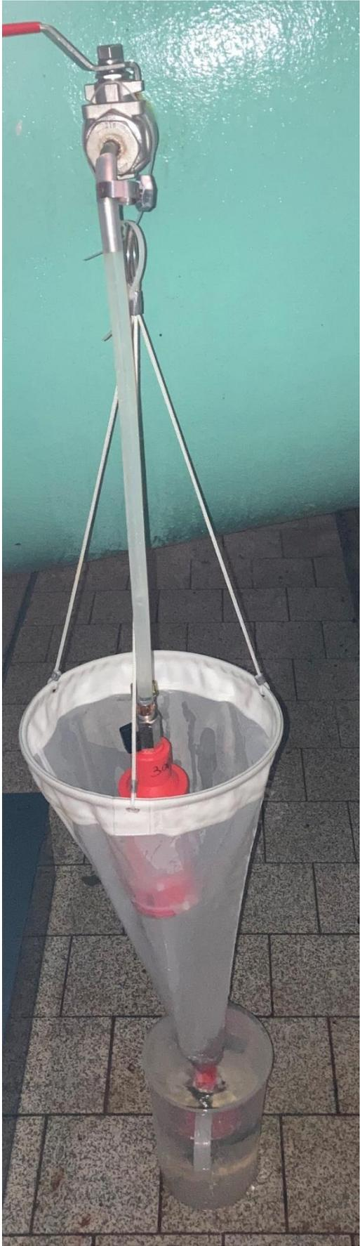
Abb. 3 Einsatz des Planktonnetzes im Bypass
