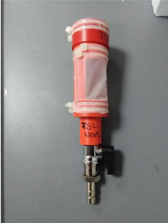
Abb. 2 Netzbecher mit Verschlusshahn
