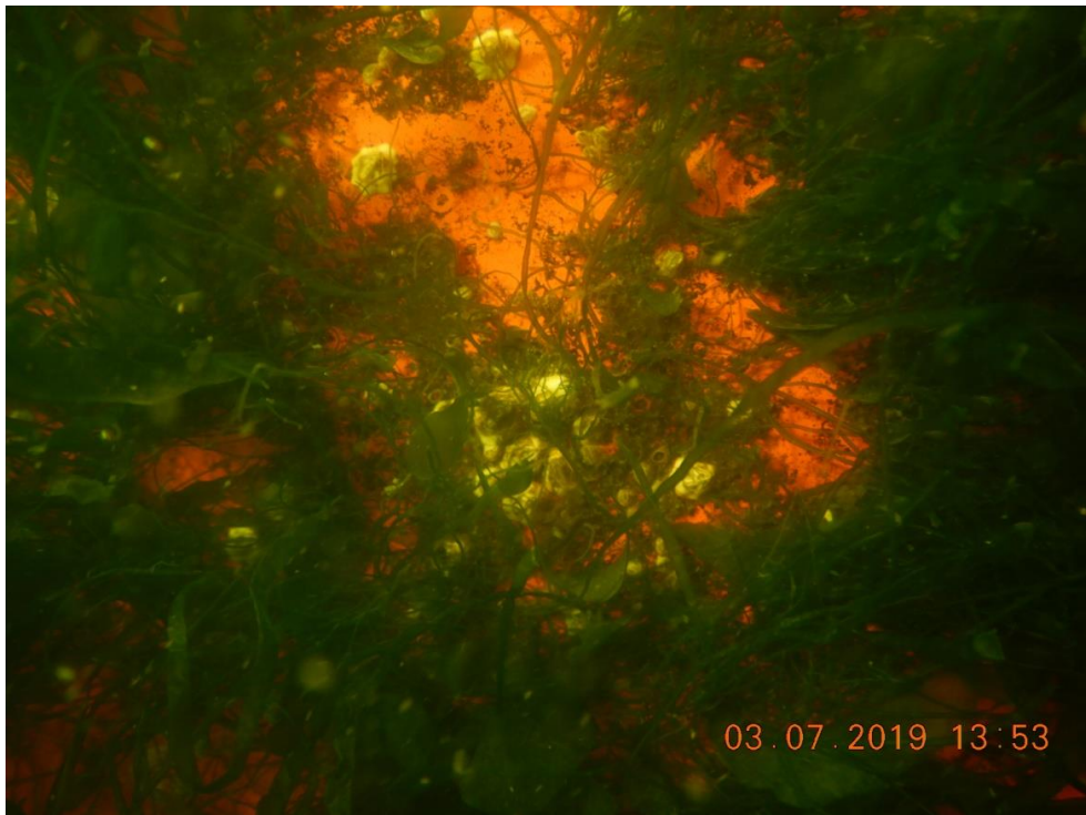
Abb. 16: Reinigungsfähige Beschichtung von Jotun auf der „Wega“ im Juli 2019, mit dichtem Bewuchs aus fädigen Grünlagen und vereinzelt Seepocken, vor der Reinigung, DG Diving
