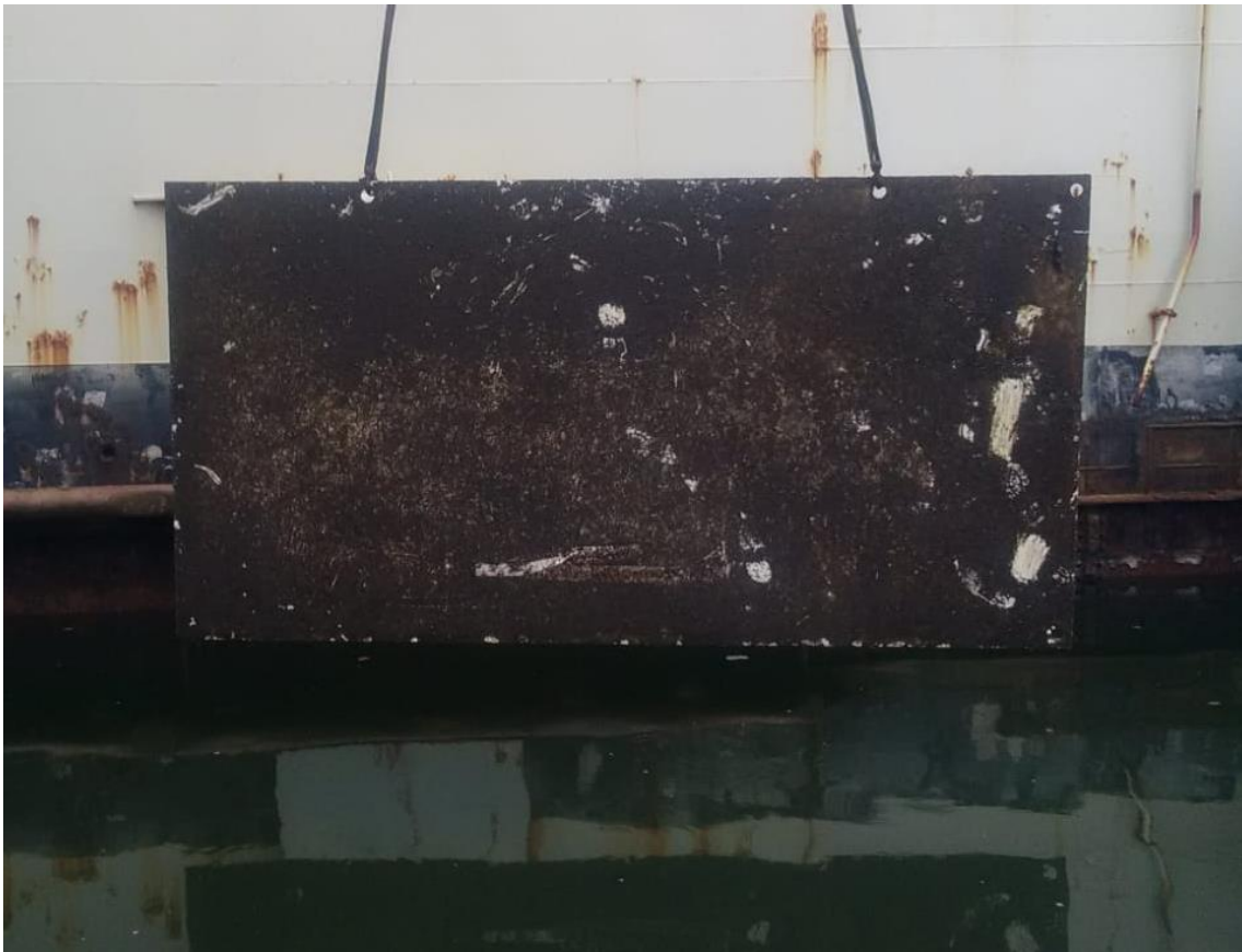
Abb. 43: Stahlplatte nach 7 Monaten Exposition vor der Reinigung
