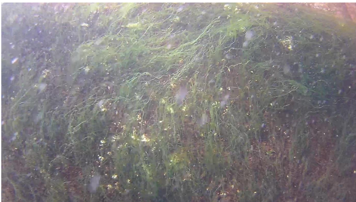
Abb. 21: Testbeschichtung von Momentive/Wohlert auf der „Wega“ im April 2019, 2 Jahre nach der letzten Reinigung mit fädigen Grünalgen und vereinzelt Seepocken, BSH
