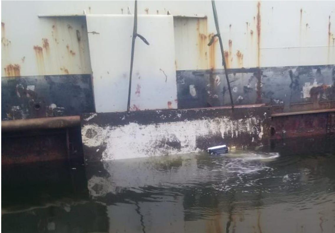
Abb. 44: KeelCrab bei der Reinigung der Stahlplatte, November 2019
