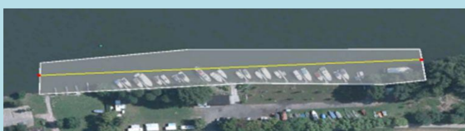
Abb. 2: Polygonzug bei offener Steganlage am Fluss zur Ermittlung der Hafenfläche (35 LP)
