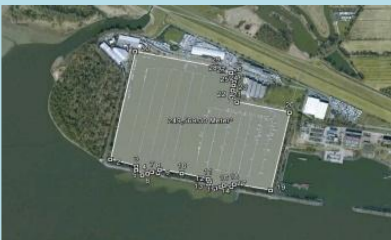
Abb. 1: Polygonzug bei einfach strukturiertem Hafen mit 2 Hafeneinfahrten (Hamburg Wedel, ca. 1800 LP)
